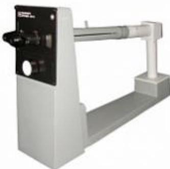
Поляриметр круговой предназначен для измерения угла вращения плоскости поляризации оптически активными прозрачными и однородными растворами и жидкостями с целью определения их концентрации.
