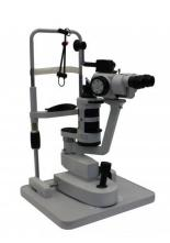
Щелевая лампа предназначена для биомикроскопического исследования переднего и заднего отдела глаза.
