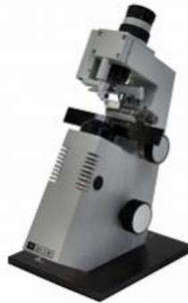
Предназначен для измерения задней вершинной рефракции и призматического действия очковых линз с расстоянием от оптического центра до края очковой линзы от 17 до 37,5 мм, нанесения положения оптического центра, положения главных сечений у астигматических линз и направления главных сечений у призматических очковых линз.
