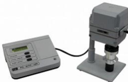
Прибор предназначен для определения качества и сортности муки на предприятиях мукомольной и хлебопекарной промышленности путем измерения коэффициента отражения и показателей белизны муки в отдельных участках, выделяемых цветным светофильтром.
